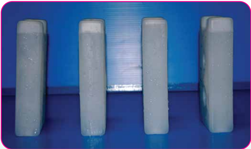
รูปที่ 15 วิธีทำ Conditioning icepack (น้ำแข็งละลายจนมีอุณหภูมิกลับมาที่ 0 องศาเซลเซียส)
